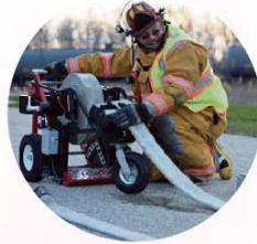
美國消防人員有使用類似「安捷」的電動開喉及收喉系統。 RollIRack Hose Management System (網上圖片)
